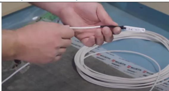
1. Připojte senzor se správným číslem na kabel.
